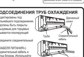
**ПОДСОЕДИНЕНИЕ ТРУБЫ ОХЛАЖДЕНИЯ ПРИ УСТАНОВКЕ ВНУТРЕННЕГО БЛОКА**
