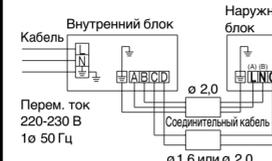
Схема соединительного кабеля в разрезе Внутренний блок
