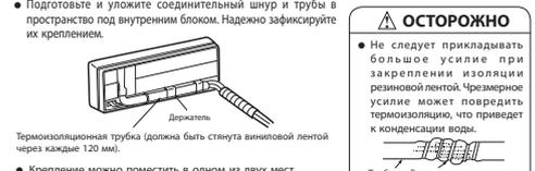
СОЕДИНЕНИЕ ТРУБ ХЛАДАГЕНТА ПРИ МОНТАЖЕ ВНУТРЕННЕГО БЛОКА
