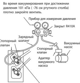
Во время вакуумирования при достижении давления 101 кПа (-76 см ртутного столба) плотно закройте вентиль.
