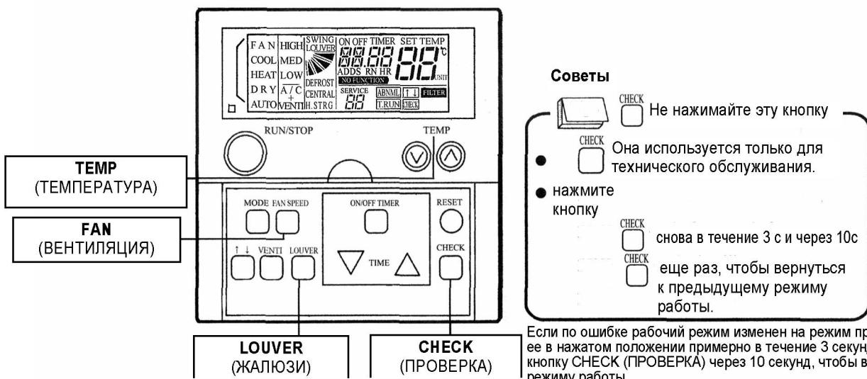
Если по ошибке рабочий режим изменен на режим проверки, то удерживайте ее в нажатом положении примерно в течение 3 секунд, а затем нажмите кнопку CHECK (ПРОВЕРКА) через 10 секунд, чтобы вернуться к нормальному режиму работы
