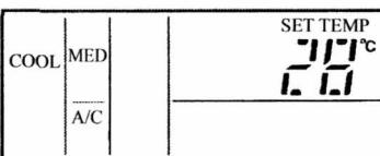
Установка температуры, скорости вентилятора и угла поворота воздухораздающих жалюзи
