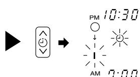
**5** Направить окно испускания сигнала пульта дистанционного управления в направлении внутреннего блока и нажать клавишу (РЕЗЕРВ). Символ (ВКЛЮЧЕНИЕ) перестанет мигать и начнет гореть постоянно, при этом загорится символ (РЕЗЕРВИРОВАНО). Раздастся звуковой сигнал, и на внутреннем блоке загорится лампа (ТАЙМЕР).
