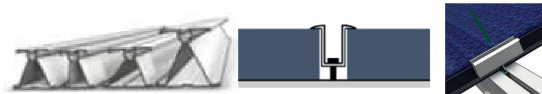
Рисунок 3 – Примеры профилей и специальных клипс для фиксации ФЭМ к профилю
