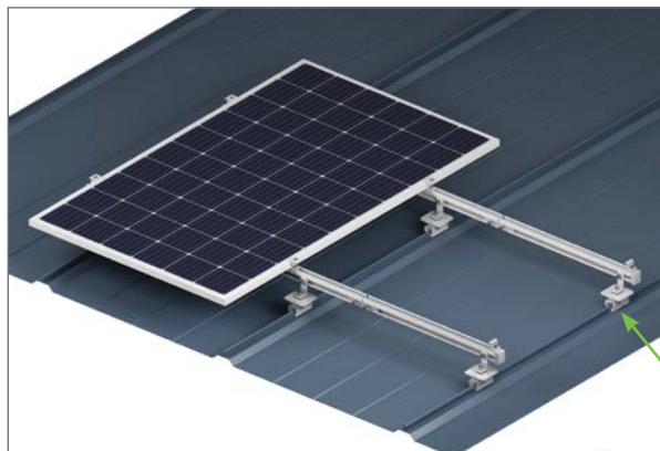
Рисунок 3.2.4 Способ крепления ФЭМ на фальцевую кровлю
