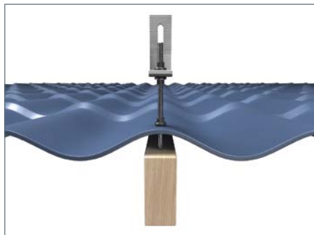
Рисунок 3.3.2 Схема установки кронштейна XMR-VI-02 на металлочерепицу или мягкую кровлю
