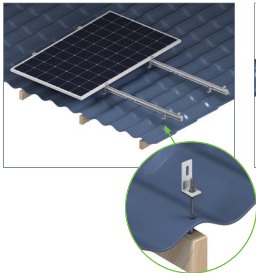
Рисунок 3.3.3 Крепежные элементы к металлочерепице или мягкой кровле
