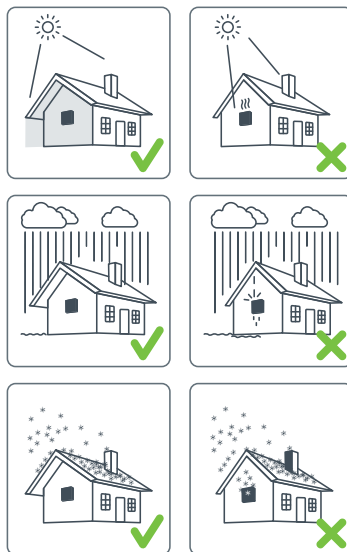
Рисунок 3.4.2 Установка инвертора на поверхность
