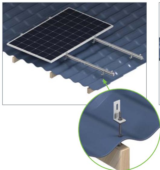
Рисунок 3.3.3 Крепежные элементы к металлочерепице или мягкой кровле
