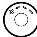
По окончании отопительного периода клапан полностью открыть поворотом против часовой стрелки, чтобы предотвратить скопление инородных частиц на седле клапана.
