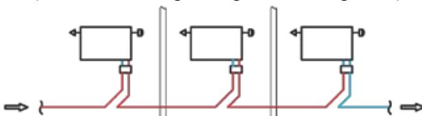
Возможные схемы разводки системы отопления с использованием комбинированного узла “ГЕРЦ-3000”.
