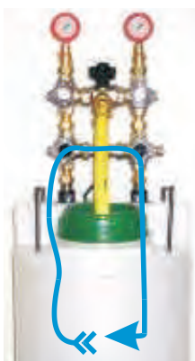
Wasserfluss über Bypassstrecke lenken.
