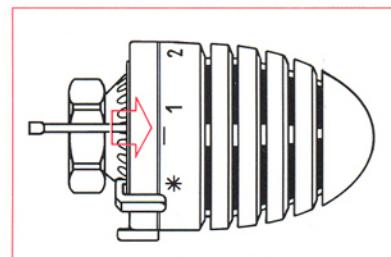
Посредством настройки маховичка на одну из имеющихся позиций настройки в помещении поддерживается температура, указанная в таблице, причем точность регулирования зависит от правильности установки терморегулятора и выбора прибора отопления.
