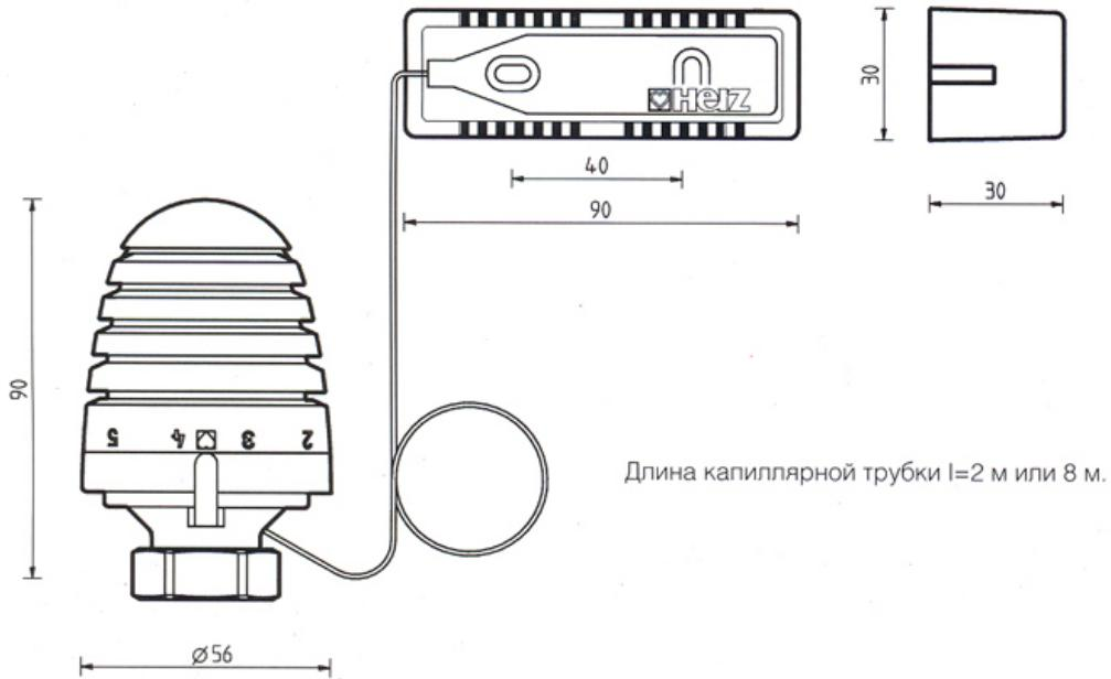
**1 9430 08 Головка термостатическая с выносным датчиком,**
