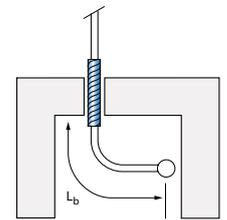
Если шахта слишком мала для размещения расчетного изгиба для расширения, то необходимо увеличить размеры отверстия в стене, чтобы дать трубе достаточное пространство для перемещения. Необходимо обеспечить изоляцию трубы в тех местах, где она проходит сквозь стену.
