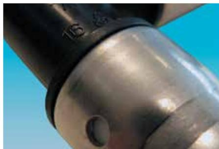
1. Проверить диаметр пресс-соединения.
