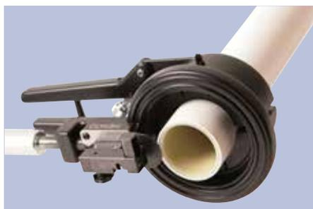
Отрежьте трубу под углом 90° резак. Резак снабжен держателем трубы.
