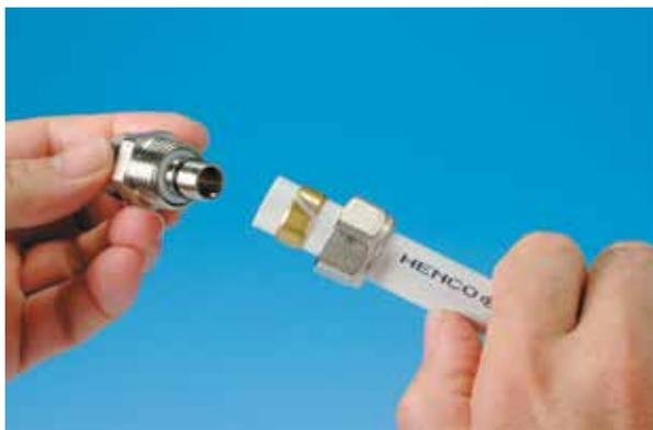
Вставить переходник или гнездо в трубу и продвинуть его до упора. Убедиться в том, что установлены пластмассовые кольца для предотвращения электролиза.
