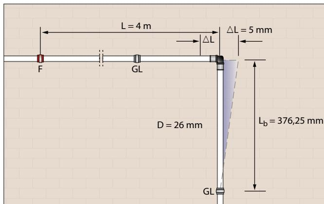
Для трубы диаметром 26 мм и длиной 4, которая изменяет направление при наличии разности температур 50 °C, требуется обеспечить изгиб длиной 376,25 мм для компенсации изменения длины.
