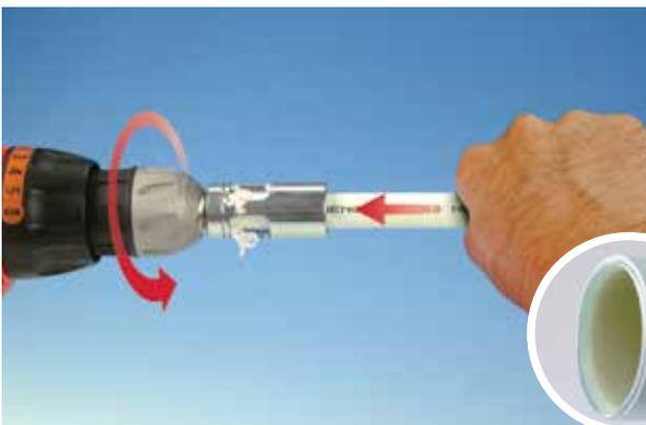
Если труба откалибрована правильно (центрирована, скошена, выровнена), то снятая фаска будет хорошо видна на всех внутренних и внешних краях трубы.
