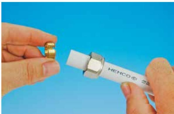
Сначала надеть накидную гайку, а затем зажимное кольцо на трубу. Можно смазать гайку синтетическим маслом для облегчения скольжения. Не использовать минеральное масло!
