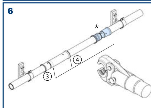
Цифрами указана последовательность пресс соединения
