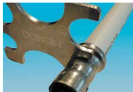
**ПРИМЕЧАНИЕ.** Измерительный шаблон PRESSCHECK подходит только для обжимных соединений, производимых с профилем Henco (профиль BE) или профилем TH (диаметром до 26 мм) в сочетании с пресс-соединением Henco из PVDF или латуни.
