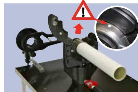
Разместите гильзу фитинга в клещах. Убедитесь, что манжета гильзы расположена в алюминиевом позиционирующем элементе. Вставьте трубу так, чтобы ее конец был виден в окошках гильзы. Сомкните клещи. Теперь можно провести опрессовку, включив гидравлический насос.
