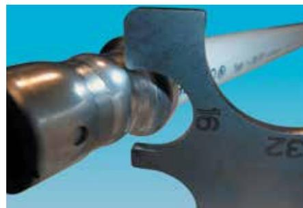
3. Ввести узкую часть обжимаемой втулки в соответствующий вырез измерительного шаблона.
