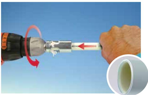
Если труба откалибрована правильно (центрирована, скошена, выровнена), то снятая фаска будет хорошо видна на всех внутренних и внешних краях трубы.
