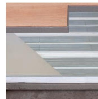
**Сухая система:** теплоизоляция укладывается на пол. Сверху кладется теплораспределяющие профили. Труба укладывается в профили. Сверху укладывается полиэтиленовая пленка, если будет заливаться бетон. Труба не контактирует непосредственно со стяжкой.
