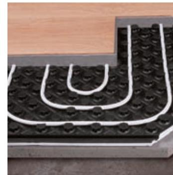
**Маты:** на плоскую поверхность укладываются маты, с или без изоляции. Трубы устанавливаются между бобышками матта. Сверху заливается бетон с пластификатором.
