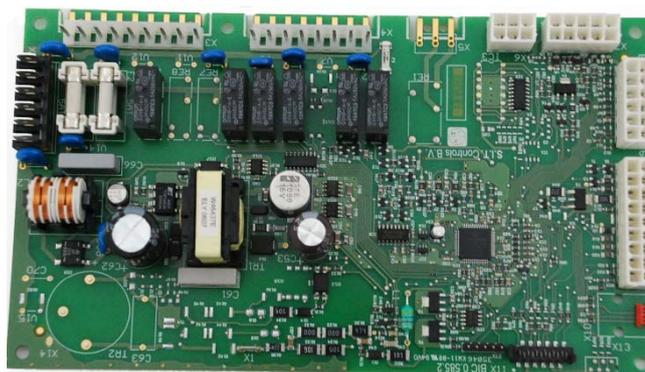
Рис. Плата управления BIC 0585202
