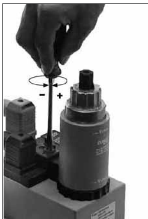
Рис.14 Регулировка динамического давления газа MB- ZR ... B01
