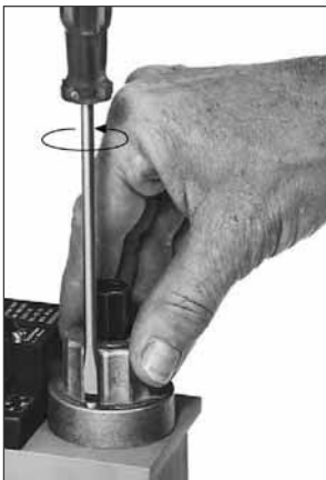
Рис.15 Регулировка главного потока MB- ... B01
