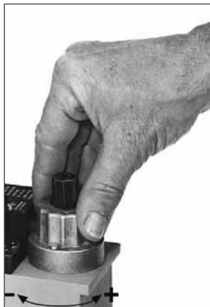
Рис.15 Регулировка главного потока MB- ... B01
