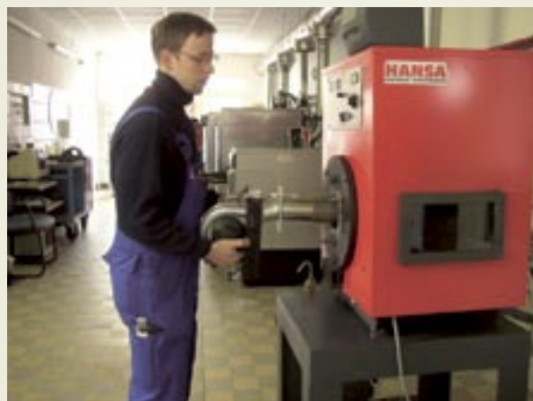
Рис.3 Горелка вставляется в топочную камеру
