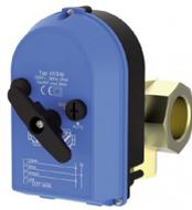
3-х ходовой зональный вентили DN 20 (3/4") для открытия/перекрытия циркуляции через контур бойлера или бака аккумулятора, DN 20, 3/4" ВР, время срабатывания 90°: 18 сек
