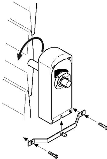
Непосредственный монтаж на вал V-образным зажимом и крепление дополнительной антиторсионной дугой.
