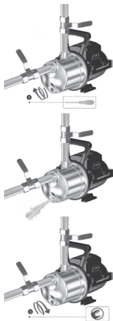
Рис. 13 Опорожнение насоса JP
