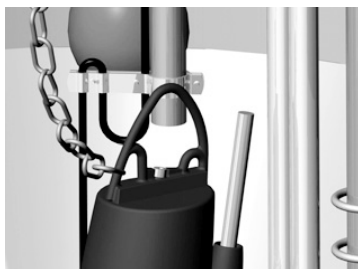
Рис. 18 Подъемная цепь, прикрепленная к насосу
