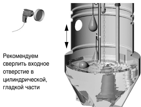
Рис. 14 Обработка отверстия под подводящий трубопровод
