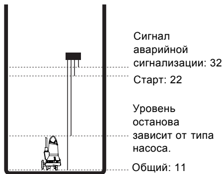
Рис. 20 Погружные электроды в канализационном колодце с одним насосом
