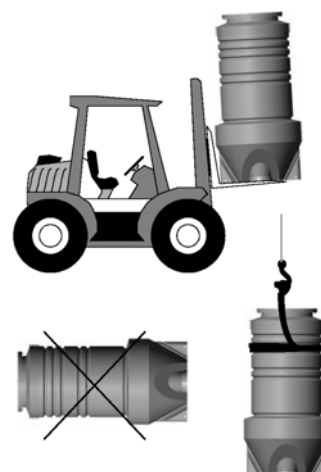
Рис. 10 Способы подъема/транспортировки колодца
