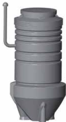
Рис. 9 Канализационный колодец с вентиляционным трубопроводом
