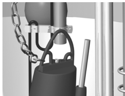
Рис. 17 Подъемная цепь, прикрепленная к насосу
