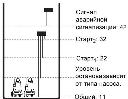
Рис. 21 Погружные электроды в канализационном колодце с двумя насосами Аварийный сигнал: 42
