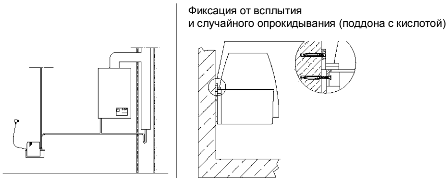
Рис. 4 Настенный монтаж с применением прихватов-угольников
