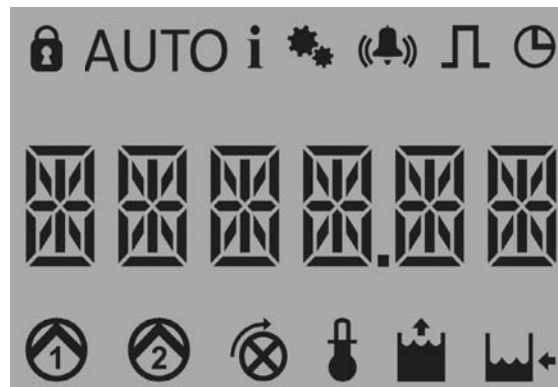
Рис. 20 Дисплей шкафа управления LC 221
