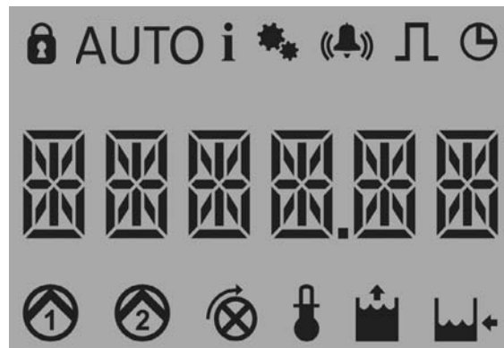
Сүр. 20 LC 221 башкаруу шкафын дисплейи
