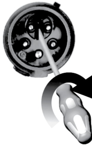
Նկար 23 Ֆազային ինվերտերով եռաֆազ կառաքարման պահարանի ֆազերի փոփոխում (< 5 կՎտ)
