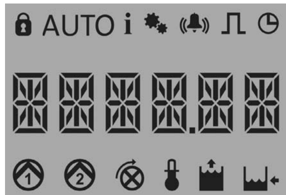
Նկար 27 Կառավարման LC 221 պահարանի էկրանը
