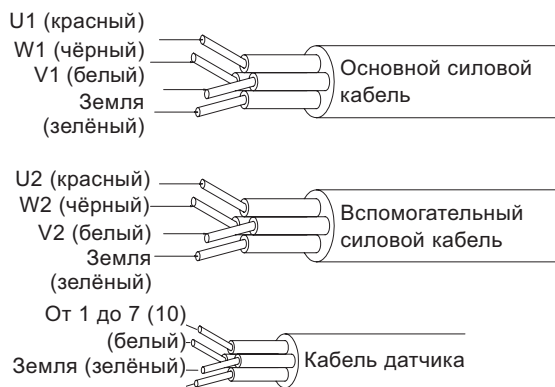
Рис. 12 Цвета проводов, пример прямого пуска от сети (DOL) с двумя силовыми кабелями
