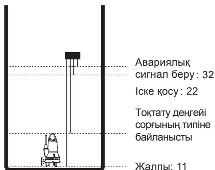
23-сур. Бір сорғымен жабдықталған кәріздік сұйыққоймадағы электродтар
