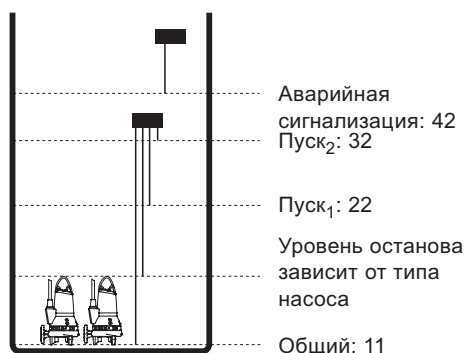
Рис. 19. Электроды в канализационном колодце, оборудованном двумя насосами
