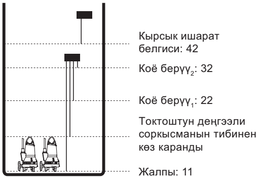
19-сүр. Эки соркысма менен жабдылган канализациялык кудуктагы электроддор.
