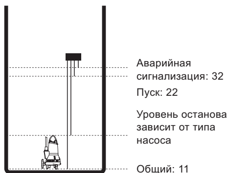
Рис. 18. Электроды в канализационном колодце, оборудованном одним насосом
