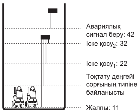
19-сур. Екі сорғымен жабдықталған кәріздік құдықтағы электродтар
