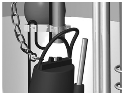
Рис. 15. Подъемная цепь, прикрепленная к насосу
