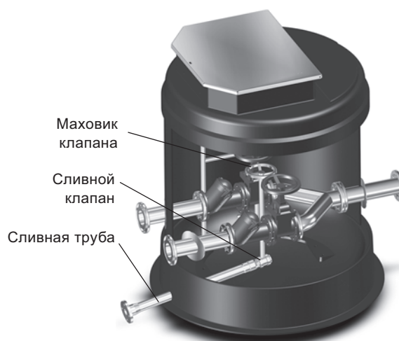
Рис. 25 Слив из камеры переключения
