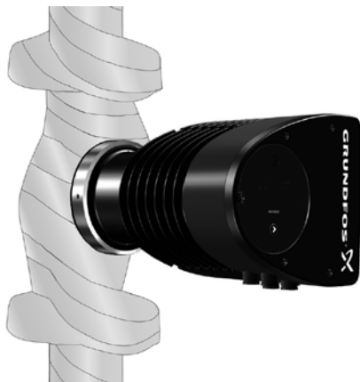
19-сур. Сорғы корпусын және құбыр желісін оқшаулау
