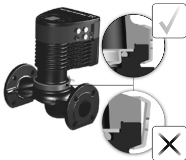
18-сүр. Соркысманын корпусуна соркысманын баш бөлүгүн бекитүү
