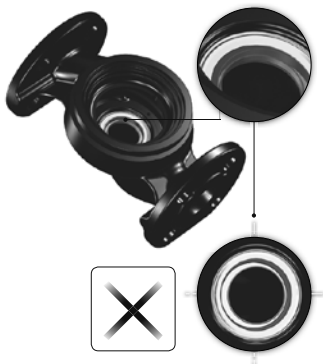
Նկար 17 հցվածքների սխալ հավասարեցրած համակարգ
