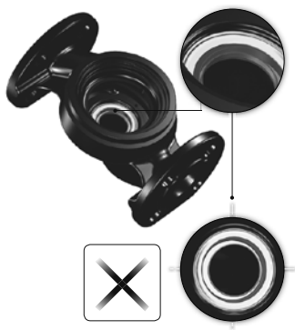
Рис. 17 Неправильно выровненная система уплотнений
