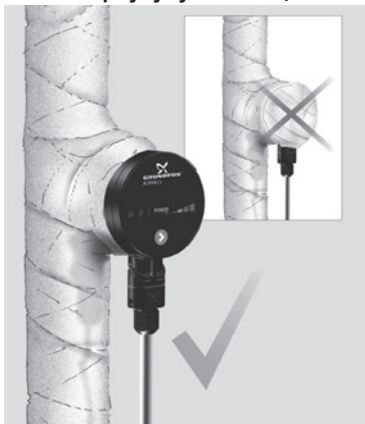
6-сүр. Соркысманын корпусунун изоляциялоо
