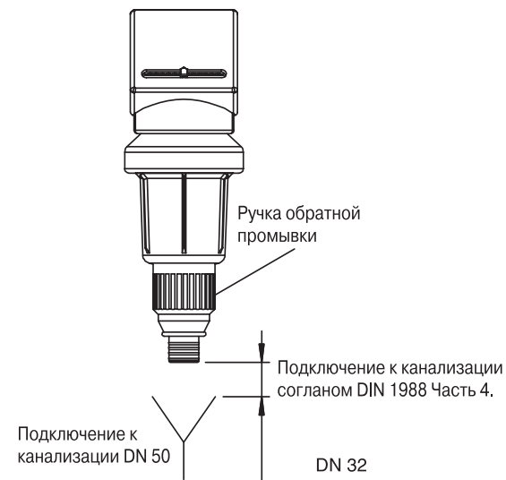
Рис. 1.1: Подключение к канализации
