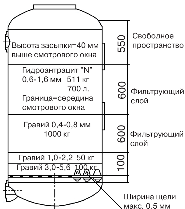
Схема засыпки установки BWK 1200
