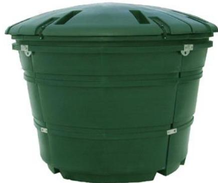
**Green Rock 10 S** является комплексной системой очистки сточных вод для частных домов ( $100 - 150 \text{ м}^2$ ). Система поделена на 4 секции: 3 секции выполняют функцию отстойника, а четвёртая – это био-фильтр, который очищает сточную воду от твёрдых веществ, органических веществ и бактерий.
