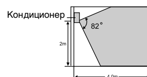
Высота установки кондиционера более 2 м
