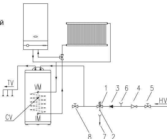
Нагреватель может подключаться к водопроводной сети в доме без редукционного клапана, если давление в ней ниже 0,6 МПа (6 бар). Если давление превышает 0,6 МПа, то требуется встроить редукционный клапан.
