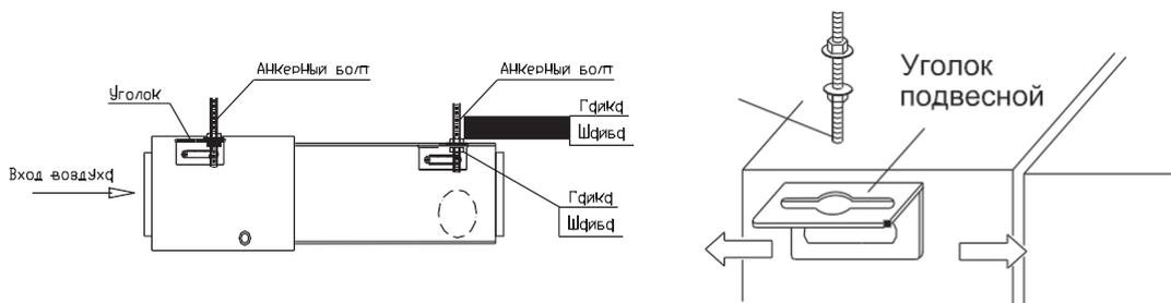
Рис. 10.26 — Установка блока
