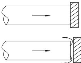
Рис. 11.11 — Снятие заглушки с трубы при возрастании давления
