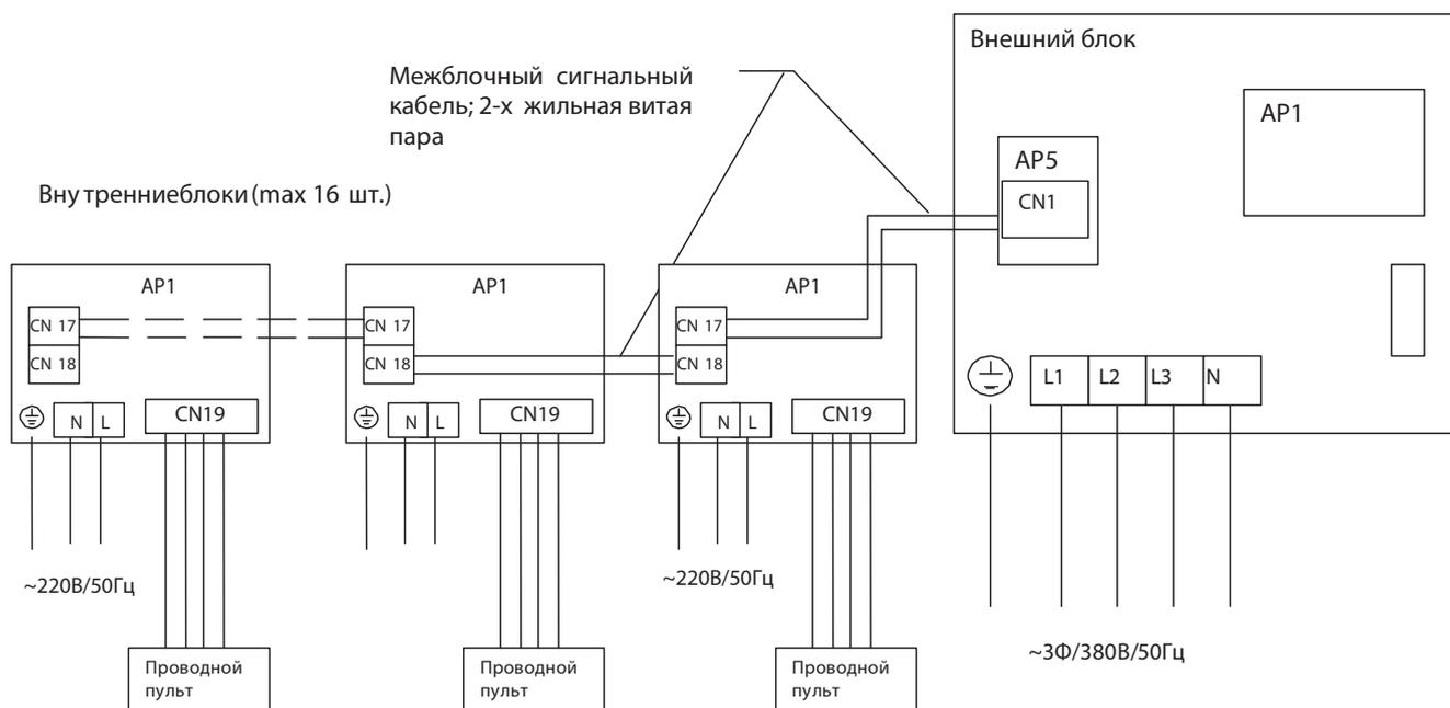
AP 1 — основная плата блока; AP 5 — Плата коммутации; XT 1 — контактная колодка
