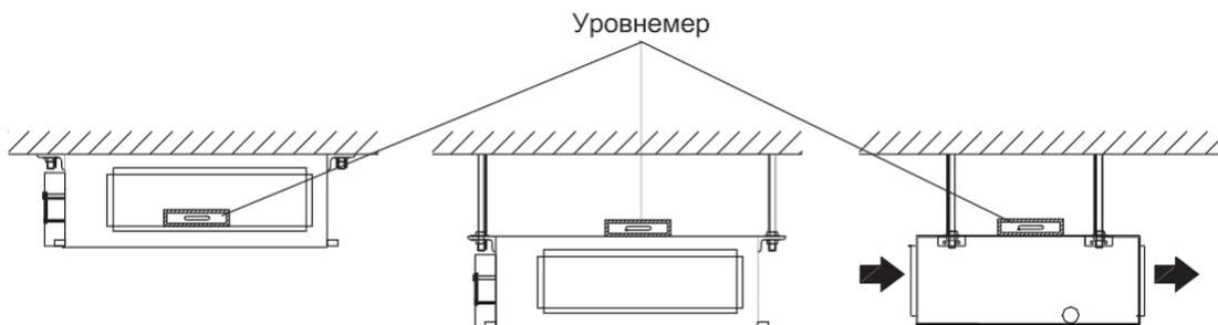
Рис. 10.28 — Выравнивание блока в горизонтальной плоскости
