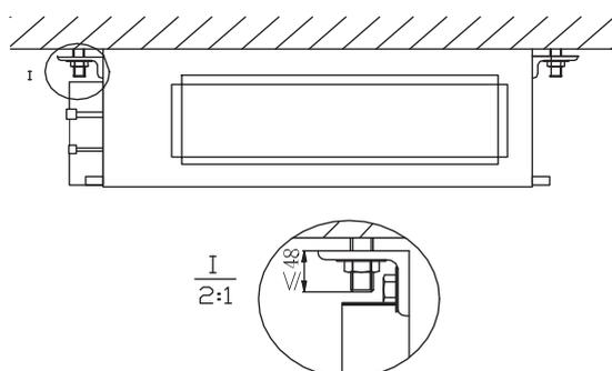
Рис. 10.27 — Крепление блока
