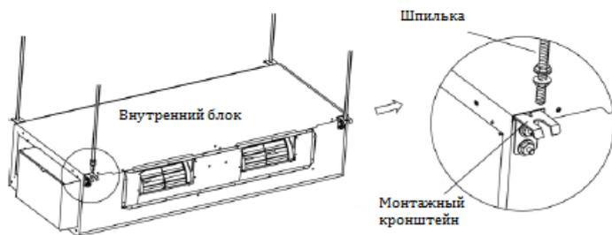
5. Поднимите внутренний блок на нужную высоту. Для фиксации внутреннего блока используйте специальные гайки.
