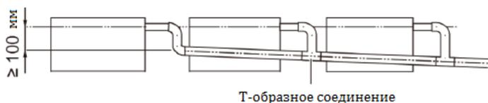
При использовании общего дренажного трубопровода для нескольких внутренних блоков необходимо использовать трубу большего диаметра в зависимости от количества и суммарной производительности блоков, а общий трубопровод должен располагаться примерно на 10 см ниже дренажных отверстий внутренних блоков.
