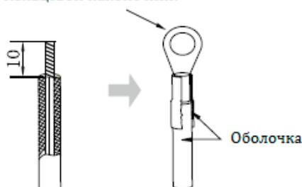
1. Зачистите конец провода примерно на 10 мм ножом или специальными клещами.
