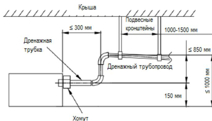
Общий дренажный трубопровод должен располагаться под уклоном не менее 1-2%. Во избежание провисания его необходимо закреплять на подвесных кронштейнах, установленных на расстоянии 1000-1500 мм друг от друга.
