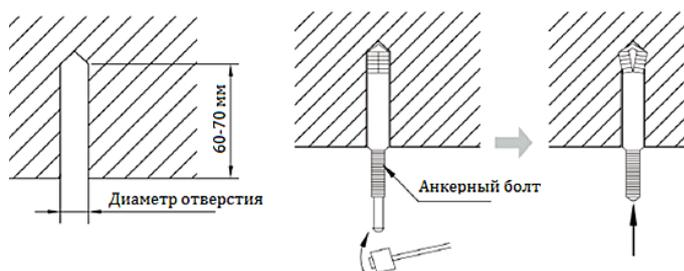
2. Вставьте анкерные (расширительные) болты М10 в отверстия и закрепите их в потолке, ударив по ним молотком.
