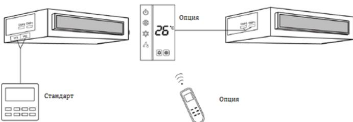
Беспроводной пульт управления не является обязательным аксессуаром. Если в комплект поставки входит беспроводной пульт дистанционного управления, то при этом внутренний блок оснащен приемником инфракрасных сигналов пульта дистанционного управления.
