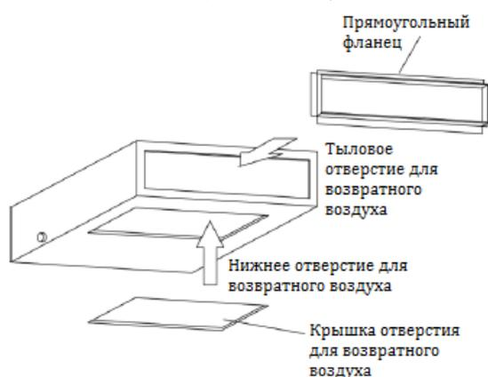
Прямоугольный фланец устанавливается в тыловой части внутреннего блока на заводе. Второе отверстие, расположенное в нижней части внутреннего блока, закрыто крышкой.
