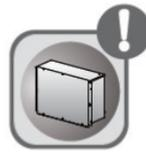
После подключения кабеля питания установите на место крышку электромонтажного короба во избежание опасности.
