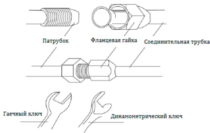
1. Соедините патрубок внутреннего блока с соединительной трубкой. Выровняйте патрубок и соединительную трубку. Закрутите фланцевую гайку вручную.
