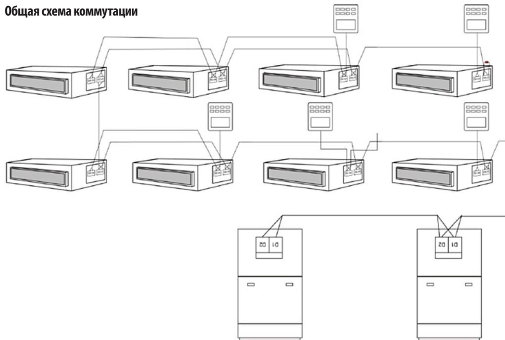
1. Провод связи, соединяющий два внутренних блока или внутренний и внешний блоки, присоединяется к разъемам D1 и D2.
