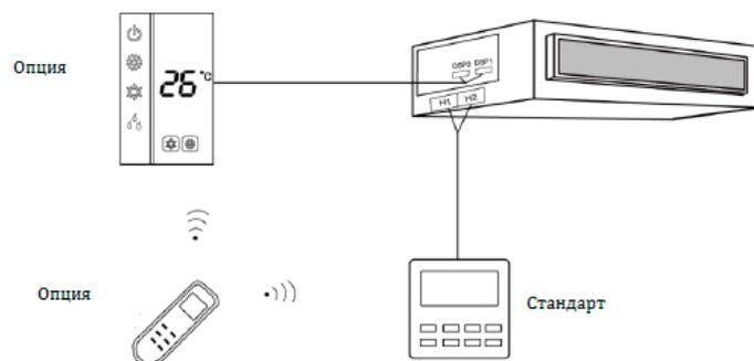
Проводной пульт управления также имеет приемник инфракрасных сигналов пульта дистанционного управления.
