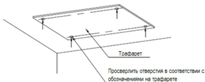
1. Используя трафарет, просверлите 4 отверстия в потолке в соответствии с обозначениями. Диаметр отверстий должен соответствовать диаметру анкерных болтов, глубина отверстий – 60-70 мм.
