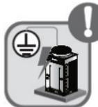
Блоки системы должны быть надежно заземлены. Запрещается подключать провод заземления к газовой или водопроводной трубе, либо телефонной линии. Во время работы системы суммарная производительность внутренних блоков должна соответствовать суммарной производительности внешних блоков, в противном случае охлаждение или нагрев воздуха будут производиться недостаточно эффективно.
