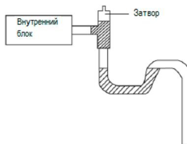
Если давление на входе в дренажную трубку высокое, рекомендуется дополнительно установить гидравлический затвор. Гидравлические затворы следует устанавливать для каждого блока.
