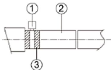
Чтобы присоединить дренажный шланг (2), наденьте его конец на дренажный патрубок (3), а затем надежно закрепите хомутом (1) или проволоочной обвязкой.
