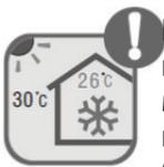
В режиме охлаждения не следует устанавливать слишком низкую температуру. Рекомендуется соблюдать разницу между уличной температурой и температурой в помещении в пределах 5°C.
