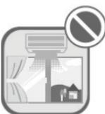
Если в том же помещении, где установлен кондиционер, используется газовый или бензиновый обогреватель, необходимо открыть дверь или окно для обеспечения нормальной циркуляции воздуха, в противном случае в помещении может возникнуть нехватка кислорода.
