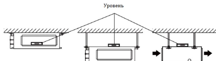
При помощи уровня убедитесь, что внутренний блок установлен в горизонтальном положении. Внутренний блок оснащен встроенным дренажным насосом и поплавковым реле. Проверьте уровень с четырех сторон с помощью уровня или виниловой трубки, наполненной водой.
