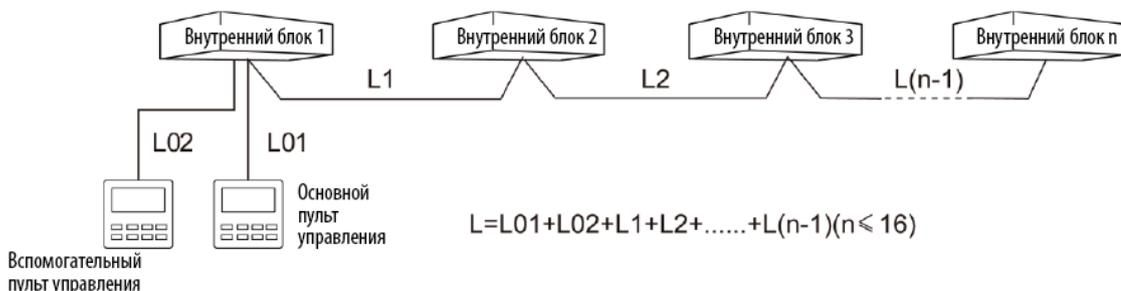
Для соединения внутреннего блока и проводного пульта управления следует использовать круглый шнур в нормальной или облегченной поливинилхлоридной оболочке (витую пару со скрученными между собой жилами) стандарта 60227 IEC 52 / 60227 IEC 53 (IEC 60227-5:2007) с площадью сечения  $2 \times 0,75-1,25 \text{ мм}^2$ .
