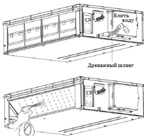
1. Наполните поддон для воды внутреннего блока водой. Для этого присоедините дренажный шланг к дренажному патрубку внутреннего блока (идущему от поддона для воды) и аккуратно, чтобы не распылять на электрические компоненты, влейте примерно 1 литр воды (по окончании испытания отсоедините дренажный шланг и закройте заглушкой отверстие к поддону) либо распылите примерно 1 л воды на испаритель внутреннего блока.
