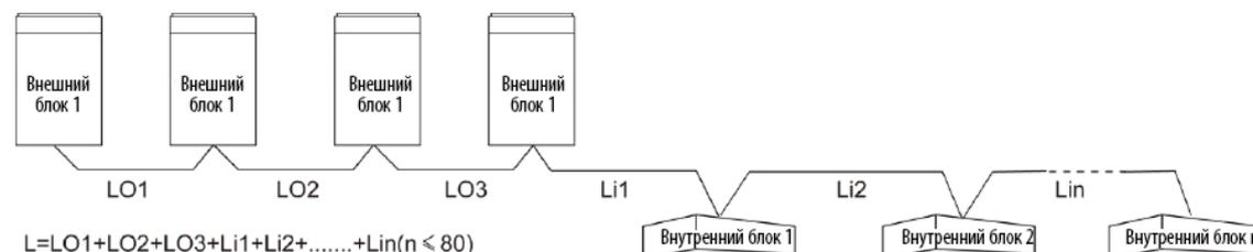
Для соединения внутренних блоков или внутреннего и внешнего блоков следует использовать круглый шнур в нормальной или облегченной поливинилхлоридной оболочке (витую пару со скрученными между собой жилами) стандарта 60227 IEC 52 / 60227 IEC 53 (IEC 60227-5:2007) с площадью сечения  $2 \times 0,75 \text{ мм}^2$ .
