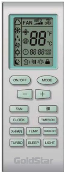
**ON/OFF** Кнопка включения/выключения кондиционера
