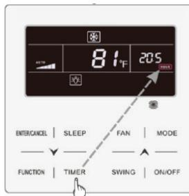
1. Чтобы установить таймер по интервалу времени, когда таймер не установлен, нажмите кнопку TIMER, чтобы перейти в режим настройки таймера, начнет мигать индикатор «HOUR».
