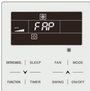
Если проводной пульт соединен с внутренним блоком с притоком свежего воздуха в зоне отображения температуры горит индикатор «FAP». В этом случае регулировка температуры кнопками ▲ ▼ недоступна. Температура исходящего воздуха в режимах охлаждения и обогрева устанавливается в настройках параметров (см. «Настройки параметров»).
