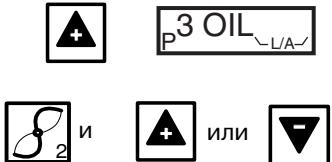
После установки параметров для **3-й ступени** нажмите на кнопку "Плюс", чтобы перейти к настройке 2-й ступени. На дисплее высвечивается 3OIL. Удерживая нажатой **кнопку 2** и нажимая кнопки "Плюс" или "Минус", можно настроить рабочую точку 2-й ступени в диапазоне от 0° до 90°.
