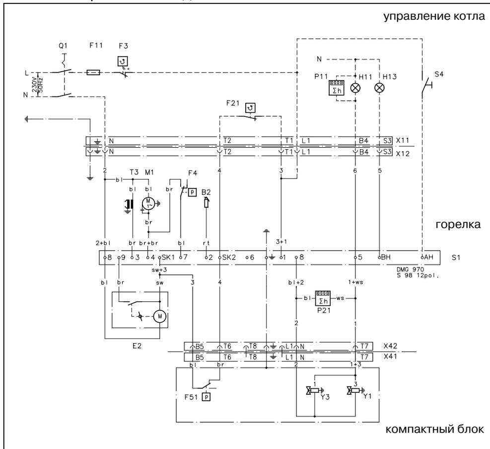
Схема электрических соединений RG20-Z-L
