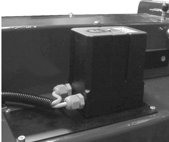
Сервопривод воздушной заслонки служит для установки воздушной заслонки у горелок с воздушным затвором. Установки задаются через электронный блок управления.
