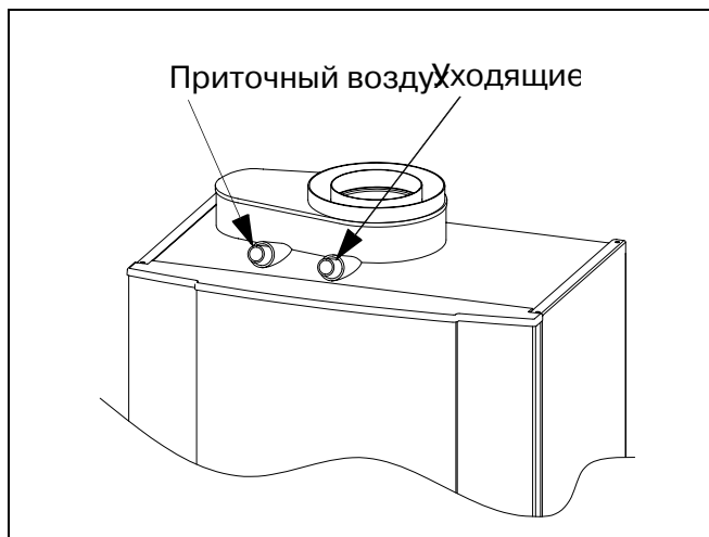
Илл. 14: Точка измерения уходящих газов
