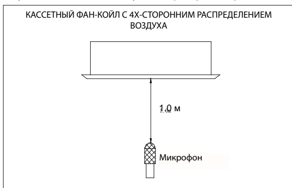
Рисунок №6 Схема испытаний шумовых характеристик агрегатов
