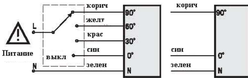
Данная схема носит рекомендательный характер, электроподключение привода следует производить в соответствии с эл. схемой, указанной на корпусе привода.
