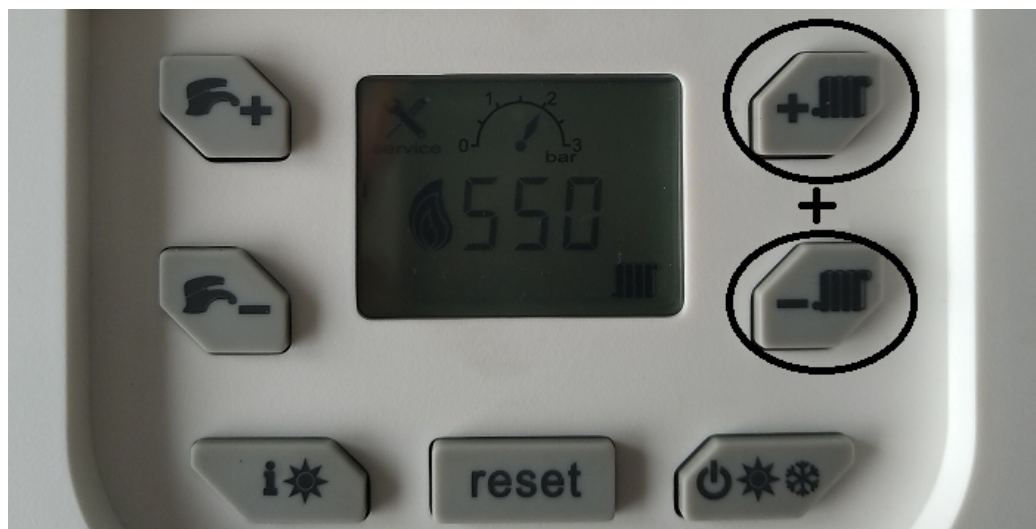
Панель управления котла
